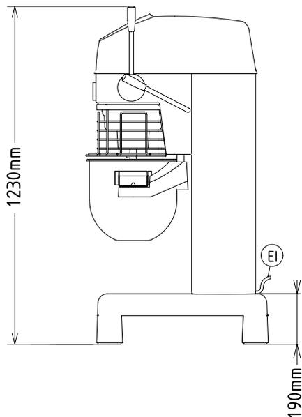
EI = Conexión eléctrica (energía)
